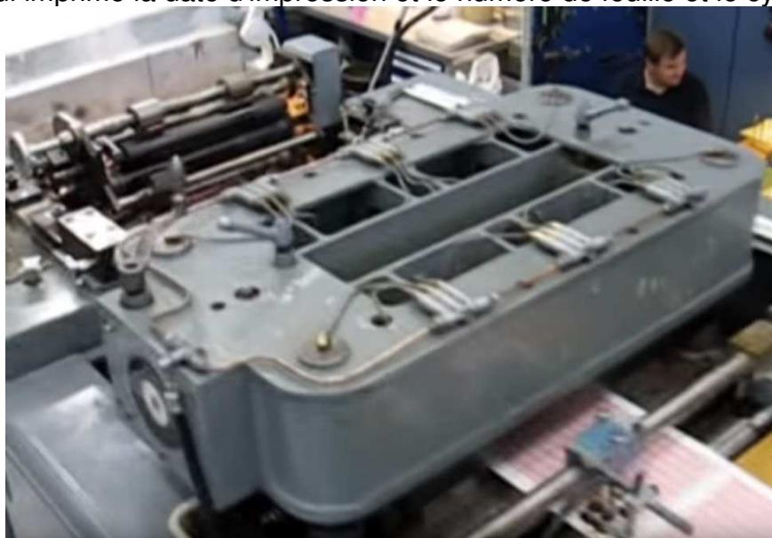
Le mécanisme de perforation
